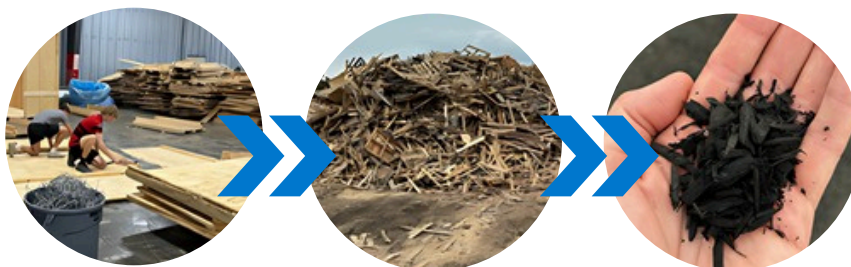
Processus de transformation des caisses en bois
